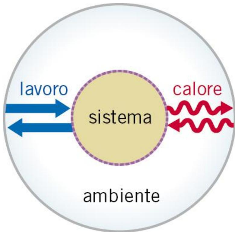
La **termodinamica** si occupa principalmente degli scambi energetici fra un sistema e l'ambiente esterno con cui esso può interagire, con particolare riguardo alle *trasformazioni di lavoro in calore e di calore in lavoro.*
